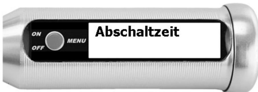
Auswahl der automatischen Abschaltzeit des Gerätes (5 Minuten / 10 Minuten / 30 Minuten / aus = das Gerät ist immer angeschaltet). **Aus** sollte nur in Sonderfällen gewählt werden, da dadurch der Stromverbrauch stark ansteigen kann. Die aktive Abschaltzeit wird mit einem Stern (\*) hinter dem Eintrag dargestellt.
