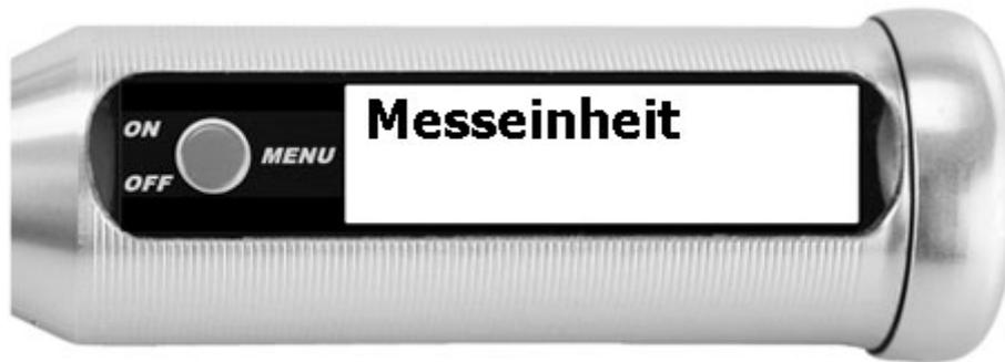
Das Gerät ist serienmäßig auf die Messeinheit A/cm eingestellt. Bei Wechsel der Messeinheit bleibt diese Wahl auch nach dem Ausschalten des Geräts erhalten. Welche Messeinheit derzeit aktiv ist, sehen Sie rechts unten neben dem Messwert.
