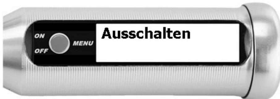
Durch langes Drücken der Taste (langer Signalton) wird das Gerät manuell ausgeschaltet.
