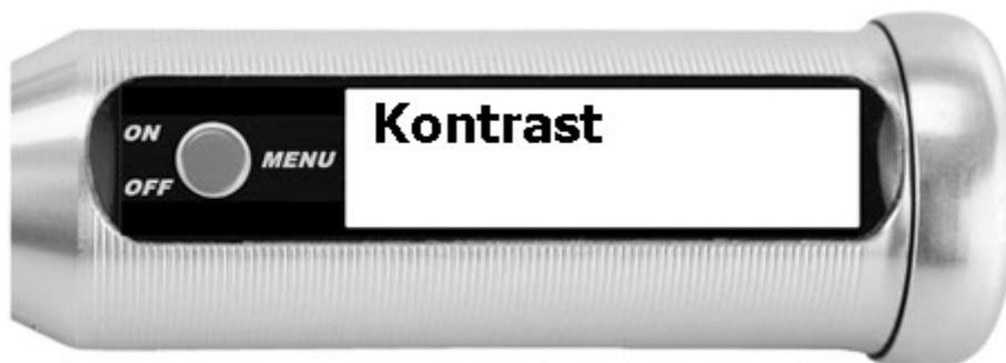
Der Kontrast der Anzeigeschrift kann auf einer Skala von 0 (kontrastarm, dunkel) bis 4 (kontrastreich, hell) eingestellt werden. Der aktive Kontrast wird mit einem Stern (\*) hinter dem Eintrag dargestellt.
