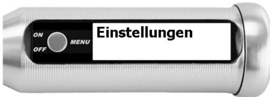
Im Einstellungsmenü können Sie Sprache, Messeinheit, Messart, Abschaltzeit, Lautstärke und Kontrast für Ihr Gerät einstellen. Diese Einstellungen bleiben bei auch nach Abschalten des Geräts erhalten. Bei einem Werks-Geräte-Reset werden diese Einstellungen gelöscht.
